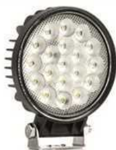
ŚWIATŁO ROZPROSZONE FLOOD LIGHT SHAPE 9-36V DC | 57 W | IP67 | 110 x 110 x 40 mm
